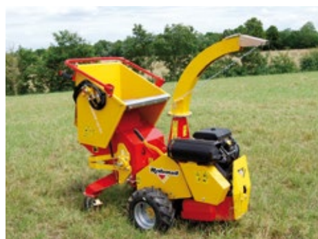
Tolva de almacenamiento plegable para una m3quina ultracompacta
