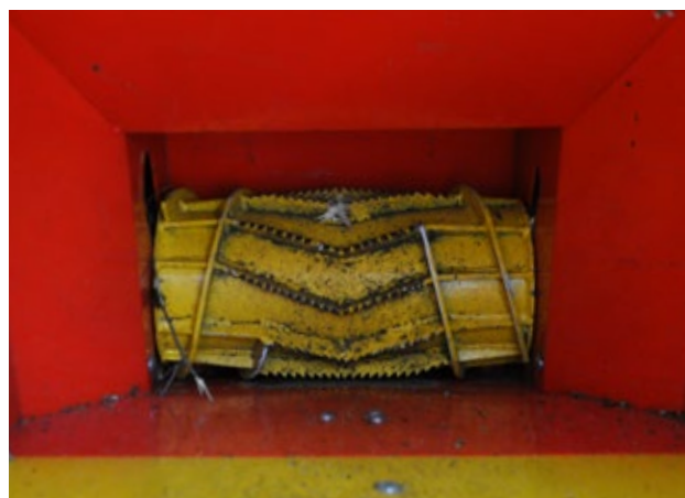
Tolva de alimentaci3n con rodillo de alimentaci3n sobredimensionado
