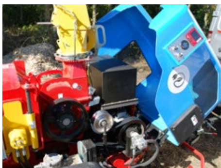
Capó de poliéster para facilitar el acceso a los componentes de la máquina
