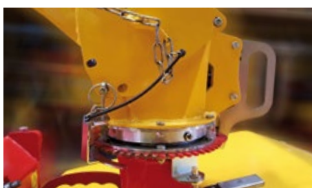
Vertedero de evacuación montado sobre un anillo de rodamientos de bolas que puede girar fácilmente 360° + sensor de seguridad en la zona de entrada
