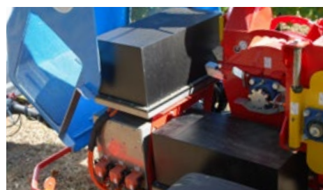
Batería de 48 V, por lo que no es necesario ser un electricista cualificado para trabajar con la máquina
