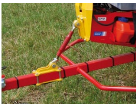
Ajuste de la inclinación del bastidor para adaptarlo a la altura de colgado
