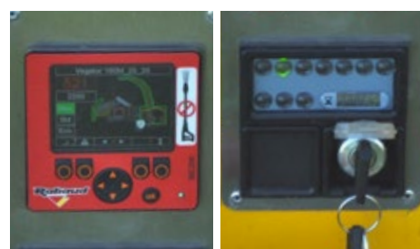
Panel de arranque con NOSTRESS de serie
